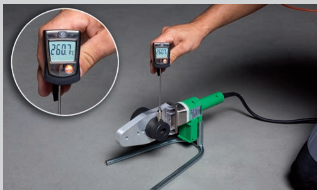
Измерение температуры на ручном сварочном аппарате aquatherm (800 Вт)
