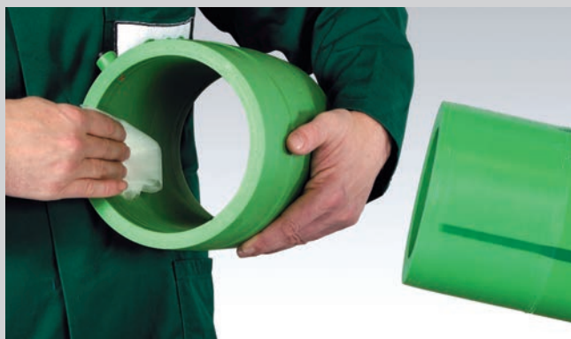
Очистка внутренней поверхности электромуфты неволокнистой салфеткой или тканью. Перед сваркой проверить, нет ли вновь образовавшейся влаги, и удалить её.
