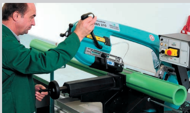
Перед сваркой отрезать трубу на необходимую длину
