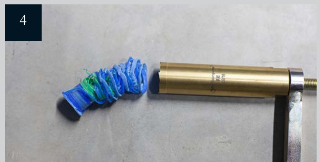
Удаление отходов сверления из инструмента
