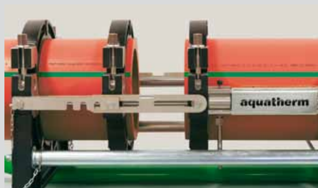
Свариваемые части вставить, выровнять и зафиксировать
