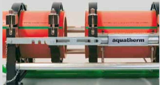
Трубы развести, удалить нагревательный элемент
