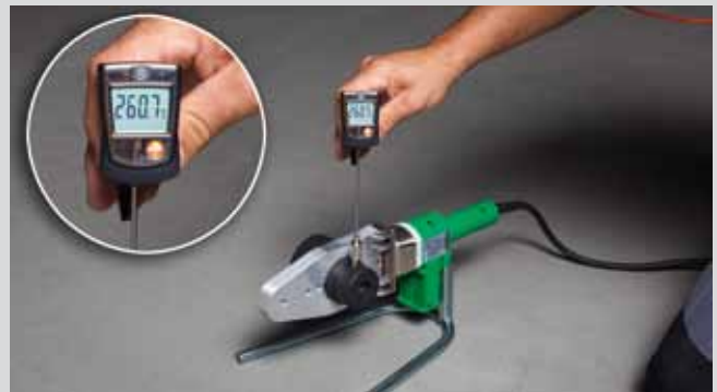
Измерение темп. на ручном сварочном приборе aquatherm (800 Вт)
