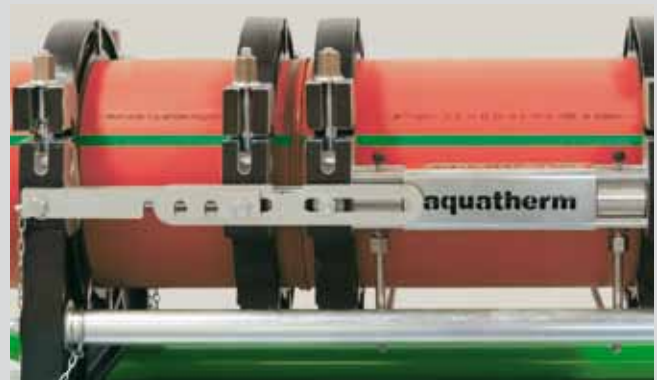
Трубы свести, под давлением дать соединению остыть
