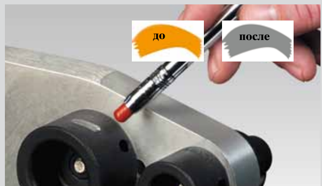
Контроль температуры нанесением штриха штифтовым индикатором температуры с изменением окраски
