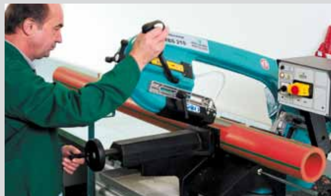
Перед сваркой отрезать трубу на необходимую длину
