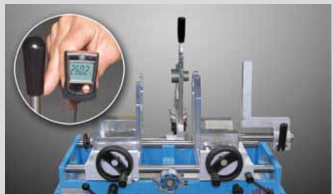
Измерение темп. на сварочном аппарате aquatherm
